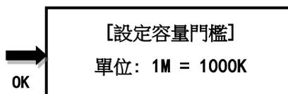
舉例說明，若容量設定 8GB(標示容量)，上限設定 10%，下限設定 10%，測得的實際容量僅有 7GB，其誤差值為 12.5%，超過設計容許值，將判定為不通過測試。
