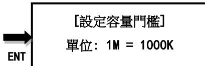
舉例說明，若容量設定 8GB(標示容量)，上限設定 10%，下限設定 10%，測得的實際容量僅有 7GB，其誤差值為 12.5%，超過設計容許值，將判定為不通過測試。
