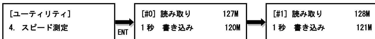
▲▼ボタンで各デバイスの転送速度表示を切り替える
